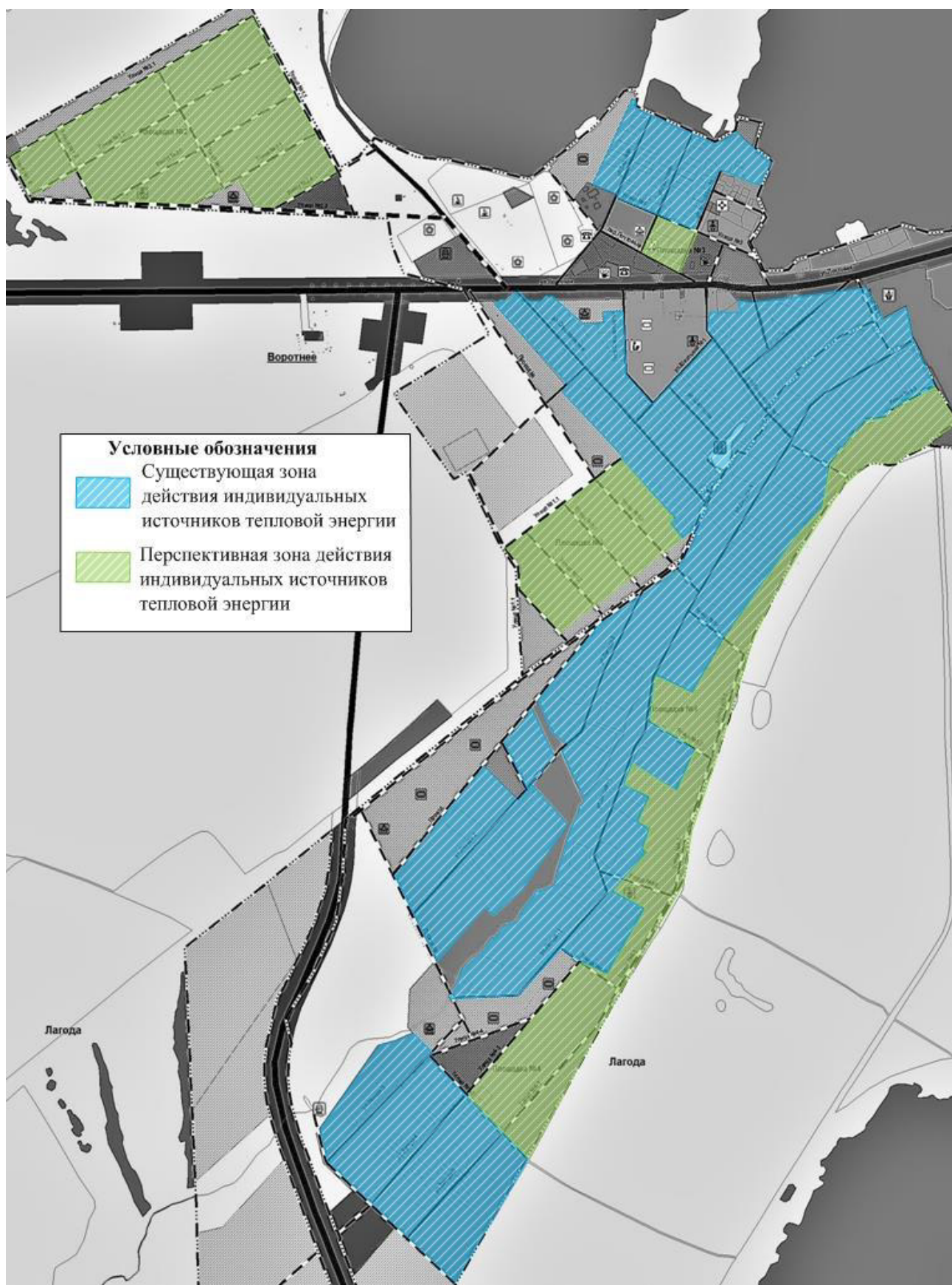
Рис. № 9 - Существующая и перспективная зоны действия индивидуального теплоснабжения на территориях села Воротнее и поселка Лагода
